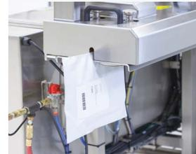
La bolsa cargada y etiquetada se sella automáticamente y sale de la empaquetadora
