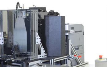
El sistema de impresión continua Print System verifica las bolsas, las pliega e inserta la documentación impresa dentro de las bolsas
