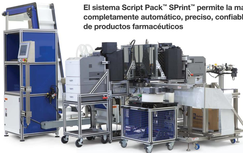
imprime e indexa de forma continua la documentación impresa a medida que los pedidos se transportan hasta la estación de empaque. Una vez que las bolsas ya verificadas y etiquetadas se desplazan hacia la posición de carga, Script Pack SPrint automáticamente las verifica, las pliega e inserta la documentación impresa correcta en cada pedido.
